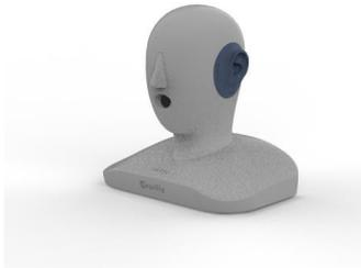
AH 263 是一款桌面型的仿真人头，能够准确再现成年人正中头部声音的传输和拾取特性，可满足各种仿真场景的声学测试需求：包括耳机声学测试，车载智能坐舱，智能家居，笔记本电脑，智能眼镜，双耳录音等等需要考虑人头架构仿真场景的声学测试应用。
